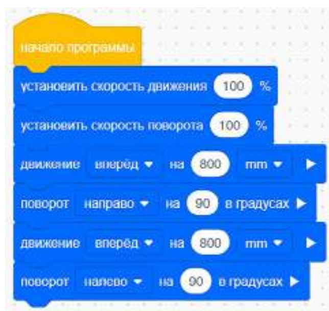
Рис. 85. Пример программы по очистке кораллового рифа
