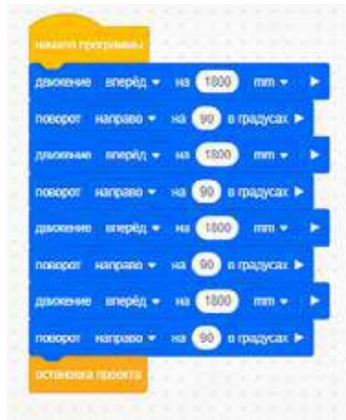
Рис. 8. Скрипт обхода VR-роботом игрового поля по периметру
