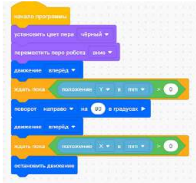
Рис. 28. Скрипт проекта с датчиком местоположения
