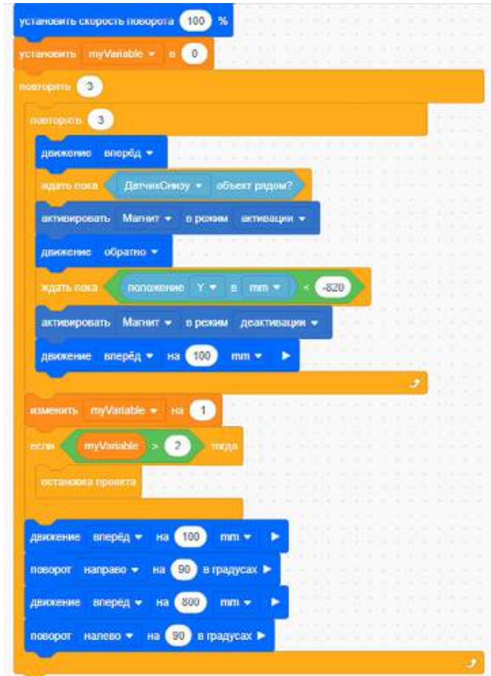
Рис. 39. Оптимизированный скрипт Перемещение фишек № 2
