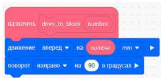
Рис. 62. Блок для перемещения VR-робота по полю
