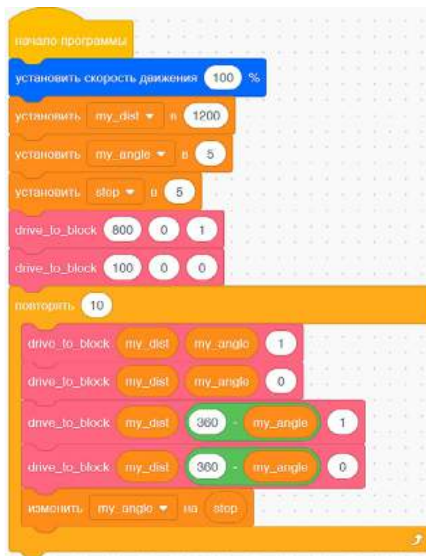
Рис. 71. Программа с шагом угла
