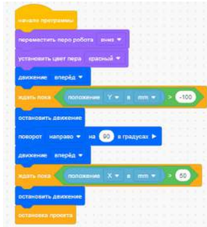
Рис. 12. Перемещение VR-робота по координатам
