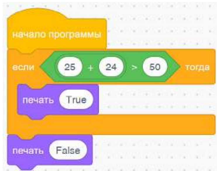
Рис. 46. Пример использования условного блока
