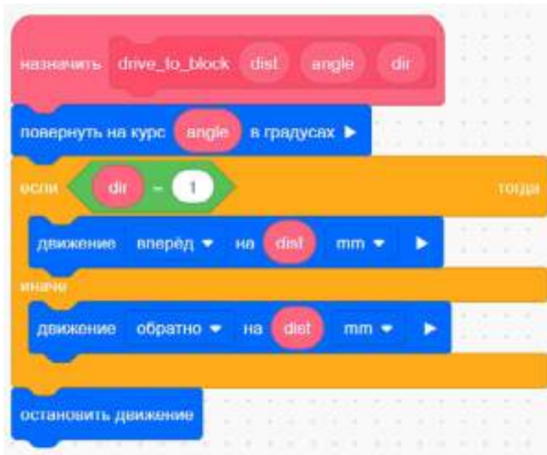
Рис. 67. Модифицированный блок движения
