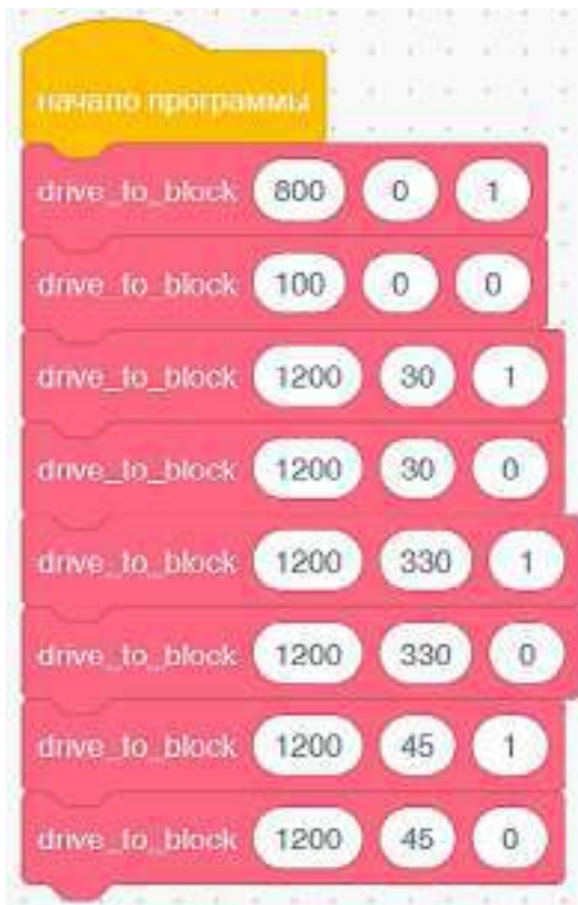
Рис. 68. Реализация алгоритма по очистке территории
