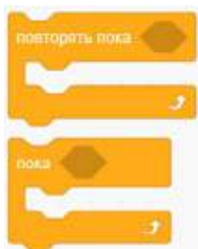
Рис. 49. Блоки циклов Повторять пока и Пока
